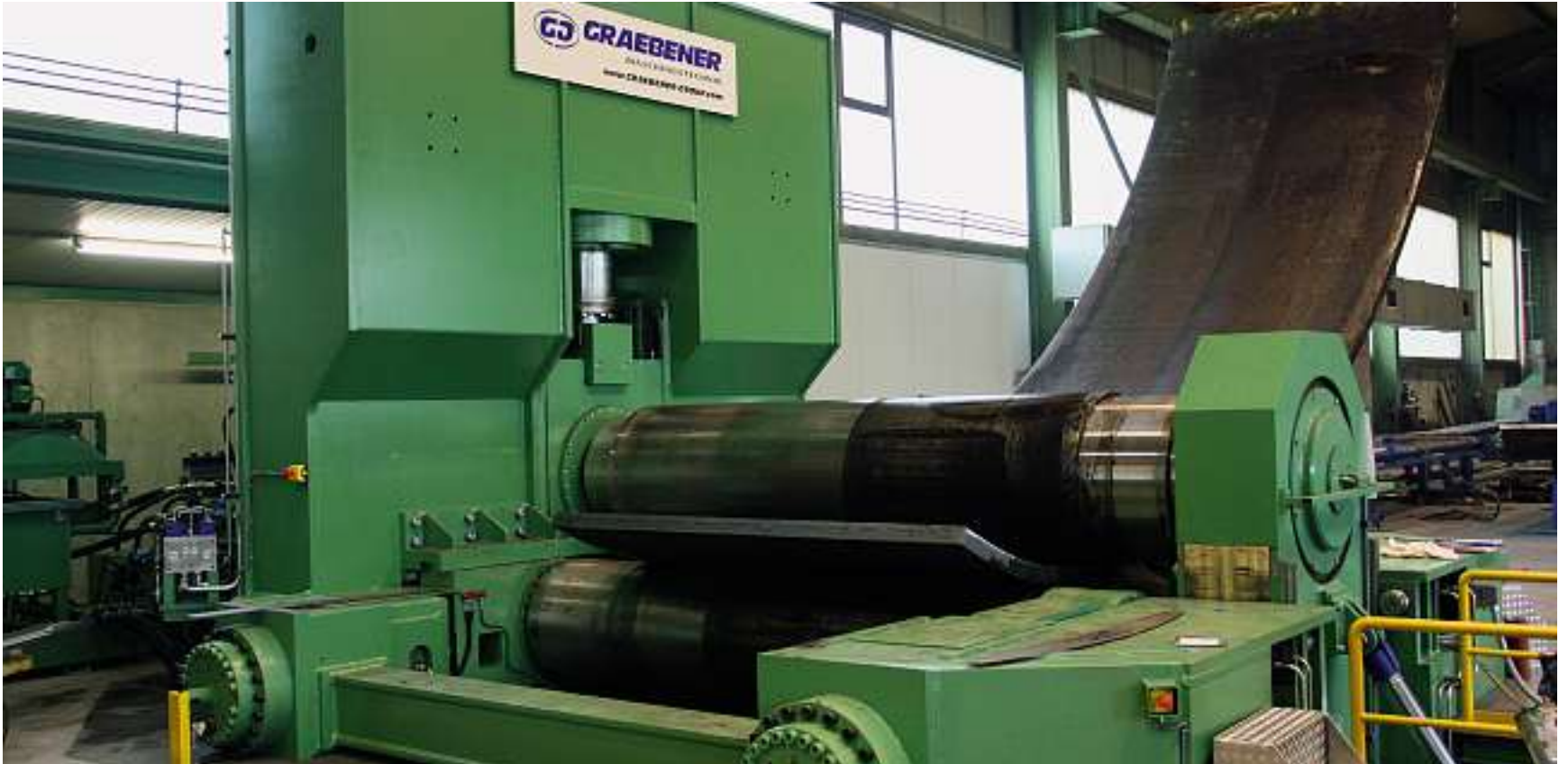
Die 3-Walzen-Biegemaschine ist ein Multitalent – zum Biegen von Rohren und Schalen, Behältern, Apparaten und auch von Konen.
