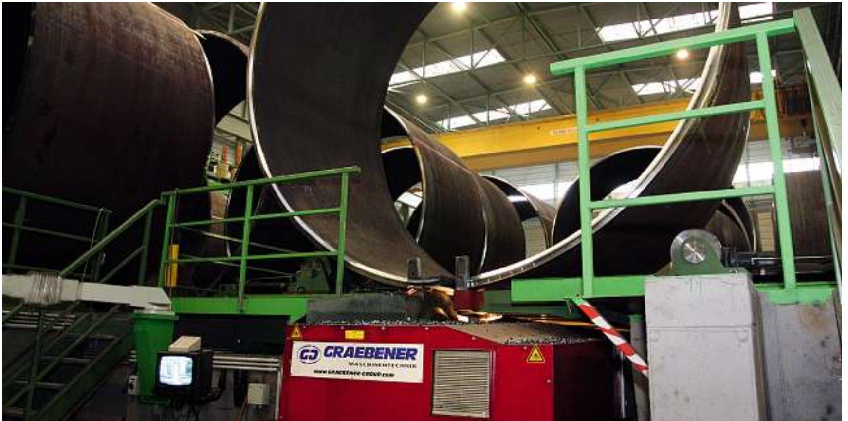
Besonders die Längs- (Foto) und die Rundnahtfräsmaschinen sind zu einem unverzichtbaren Bestandteil der Windturmfergigung geworden.
