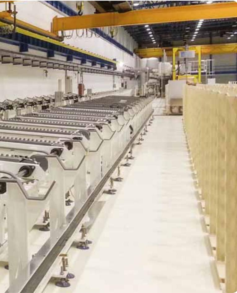
Адьюстажные линии применяются для бесшовных труб, так как исходные длины различны и обычно требуется повышенные требования к неразрушающему контролю труб. Особенно для горячекатаных труб возможны существенные сокращения расходов на Персонал и обрезь. Начиная с трубоправильной машины и НКТ, порезки на товарные длины, до фаски и упаковки системы могут быть автоматизированы.
