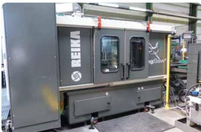
Более 10 лет Reika предлагает специально для порезки толстостенных труб больших диаметров из высокопрочных сталей инновационные пилы RingSaw®, оснащенные вращающейся режущей головкой с кольцевым инструментом с внутренними зубьями. Целью как всегда является экономичность процесса у заказчика и точность при высокой производительности.
