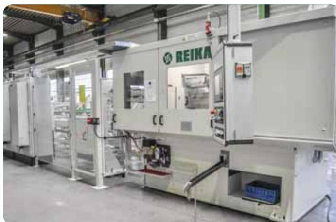
Hace más de 10 años que Reika ofrece la sierra anular RingSaw® como sierra innovadora provista de un cabezal de sierra giratorio y engranaje dentado interior, particularmente idónea para espesores de pared y diámetros grandes así como para dureza altas de material. Nuestro objetivo es siempre la alta rentabilidad para el cliente en combinación con excelentes prestaciones de calidad.
